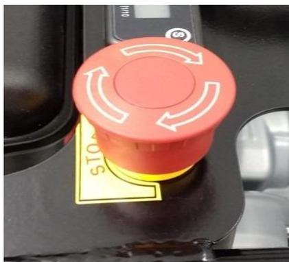
**\* Em caso de emergência acione o botão de emergência, localizado no cabo de manobra**
