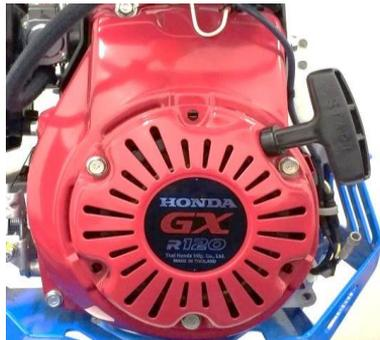
**\*Deixar aquecer o motor durante alguns minutos e mover o afogador para a posição "fechado" e o acelerador para a posição de velocidade máxima para começar a compactar.**
