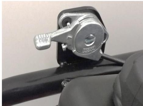
\* **SOMENTE** ACIONE O MOTOR – PRÓXIMO PASSO - COM A ALAVANCA EM VELOCIDADE MÍNIMA.
